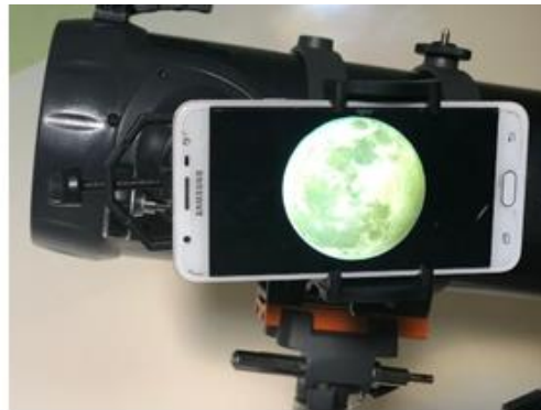
Figura 21 - Celular com adaptador suporte acoplado ao telescópio
