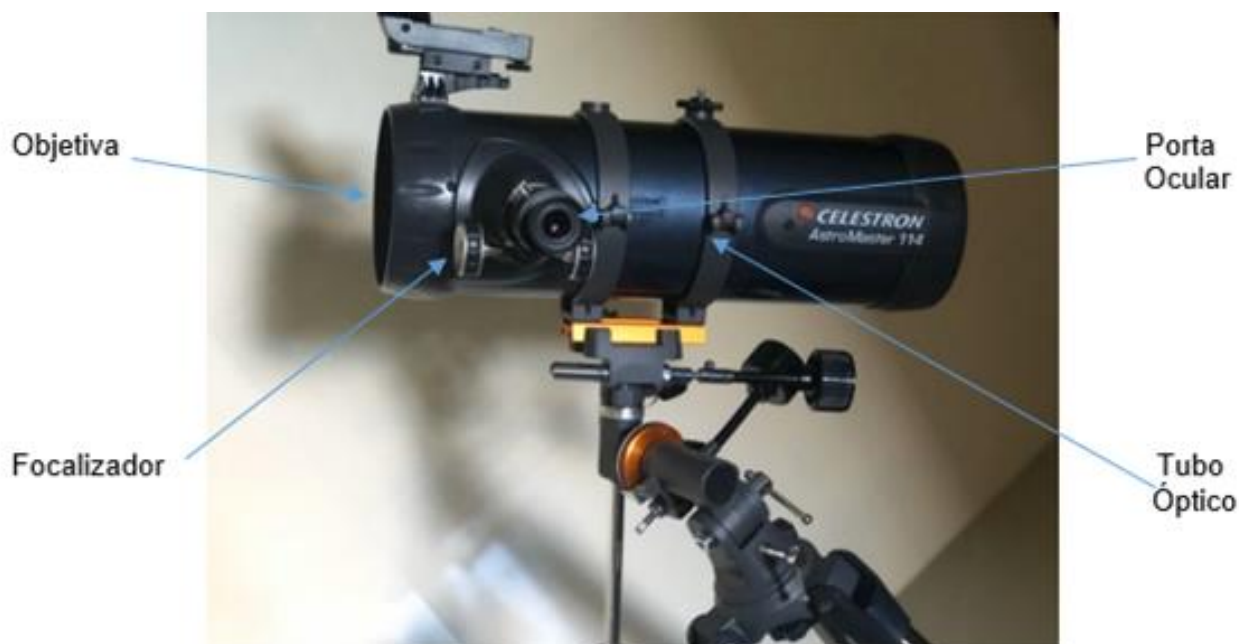
Figura 19 - Componentes do tubo óptico de um telescópio
