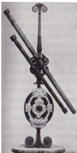
Figura 16 - Luneta construída por Galileu em 1609
